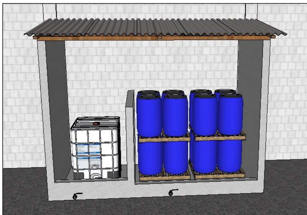
Figura 60. Armazenamento temporário, com dique área de contenção
