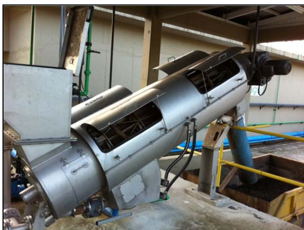
Figura 5.55 - Desidratação de lodo e lodo desidratado.
