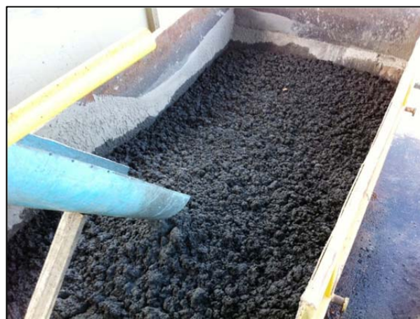
Figura 5.55 - Desidratação de lodo e lodo desidratado.
