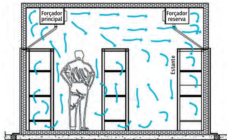
Figura 10 Convecção forçada no interior de uma câmara frigorífica
