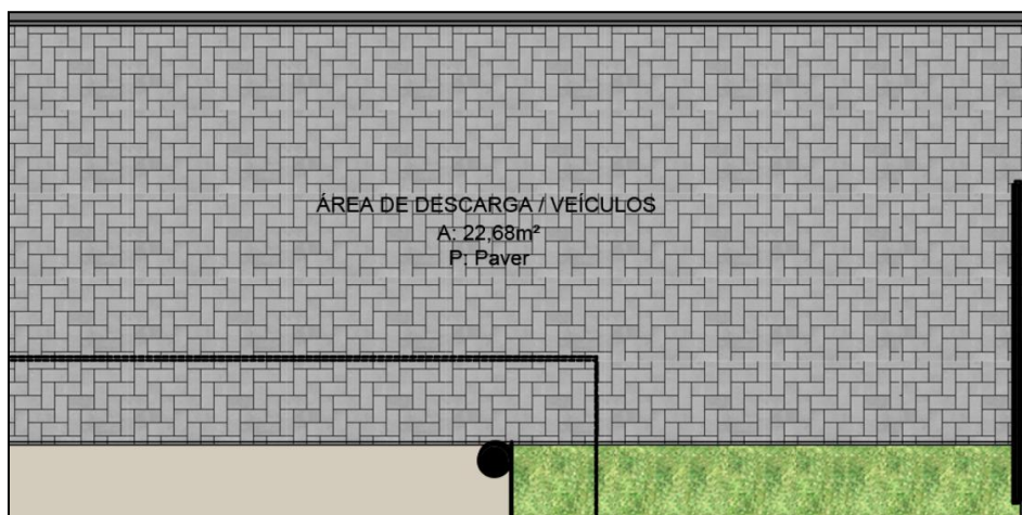
Imagem 12 - Piso Paver em Área de Descarga de Veículos
