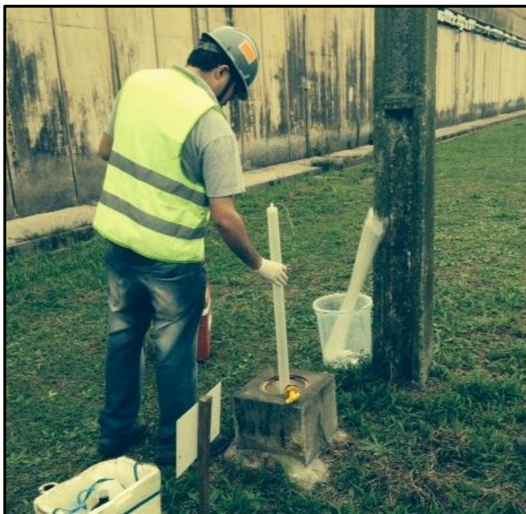
Figura 52 – Registro fotográfico do procedimento de coleta de amostra de água subterrânea executado no poço (PM-02) em junho/2014.
