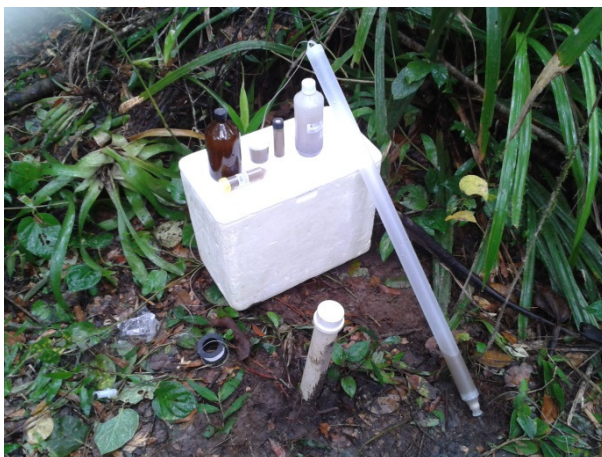
Figura 3-9 - Frascaria utilizada no acondicionamento das amostras de água coletadas nos poços de monitoramento.
