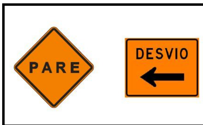
Figura 6-5 - Exemplo de placas de sinalização de obra.
