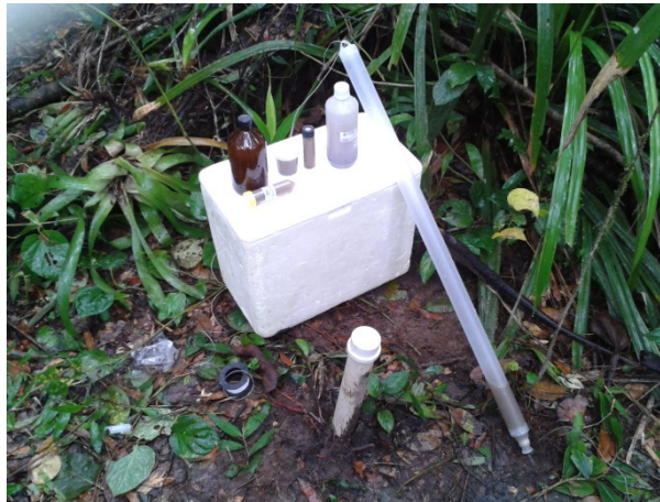
Figura 4-22 - Frascaria utilizada no acondicionamento das amostras de água coletadas nos poços de monitoramento.
