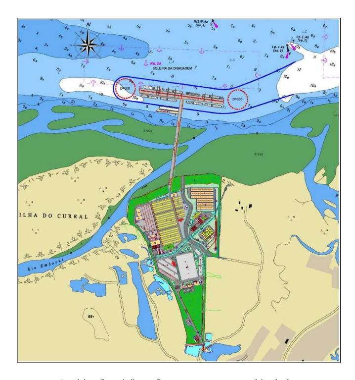
A próxima figura indica graficamente, por sua vez, a soleira de dragagem representada pelas cores de azul profundo, de modo a possibilitar duas bacias de evolução de diâmetro de 300 m.
