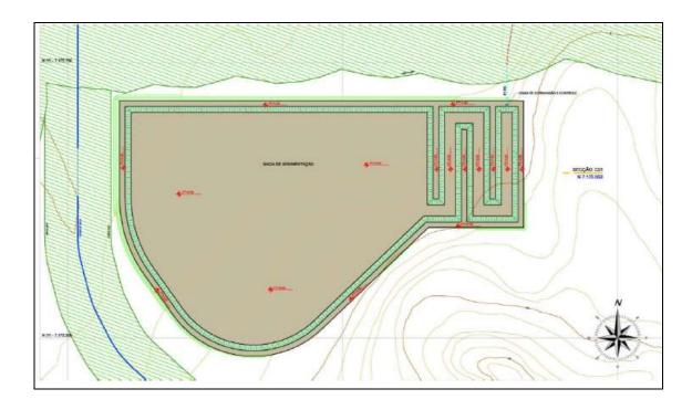
Este estoque, tal como concebido, permitirá uma reposição de 25 vezes. Assim, o período de sedimentação e secagem é calculado pelo período previsto pela produtividade do equipamento dividido pela reposição.
