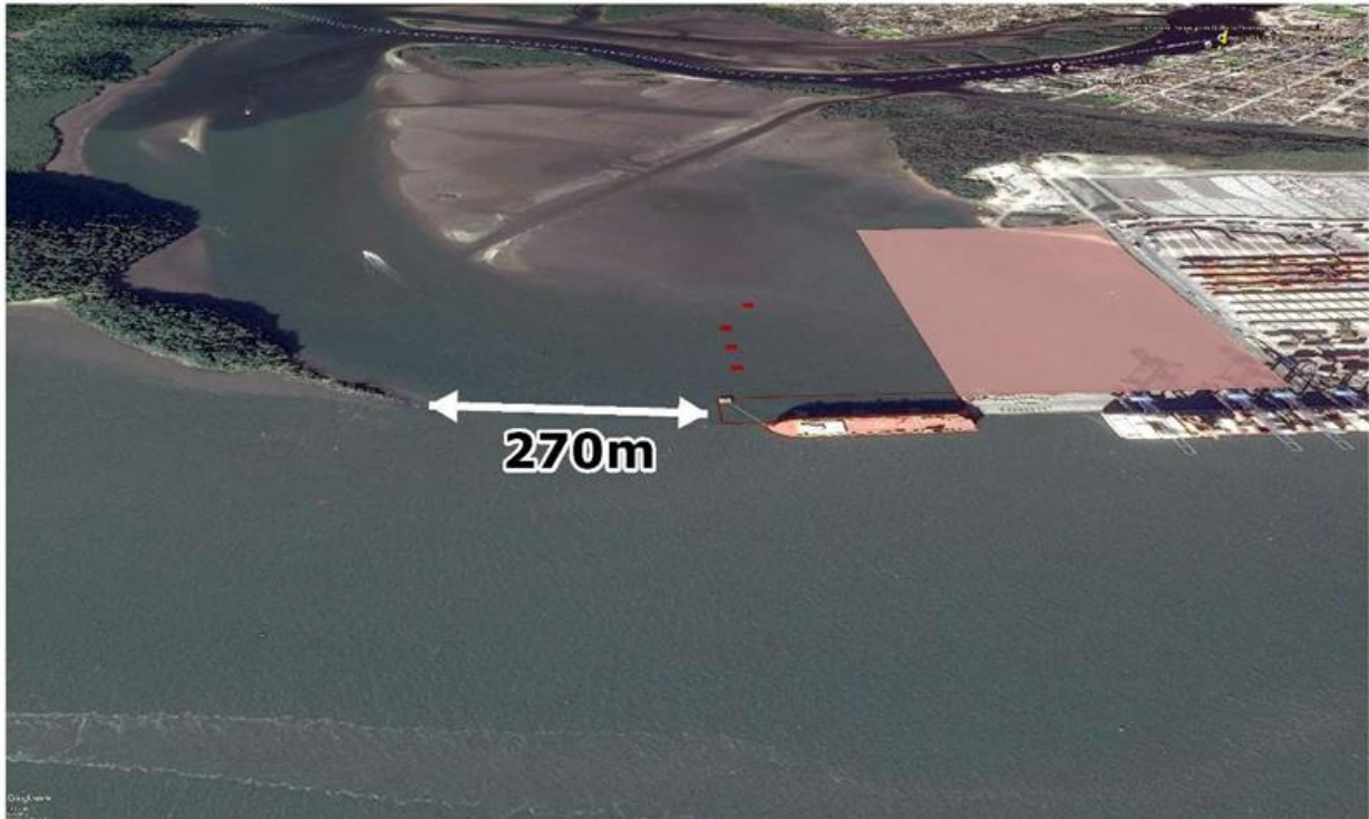
Figura 12 - Ampliação do cais leste com a diminuição da seção livre do canal da Cotinga para 270 metros.
