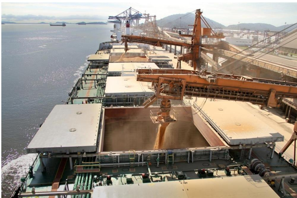
**Figura 15.** Dois carregadores de navios operando simultaneamente em um mesmo graneleiro
