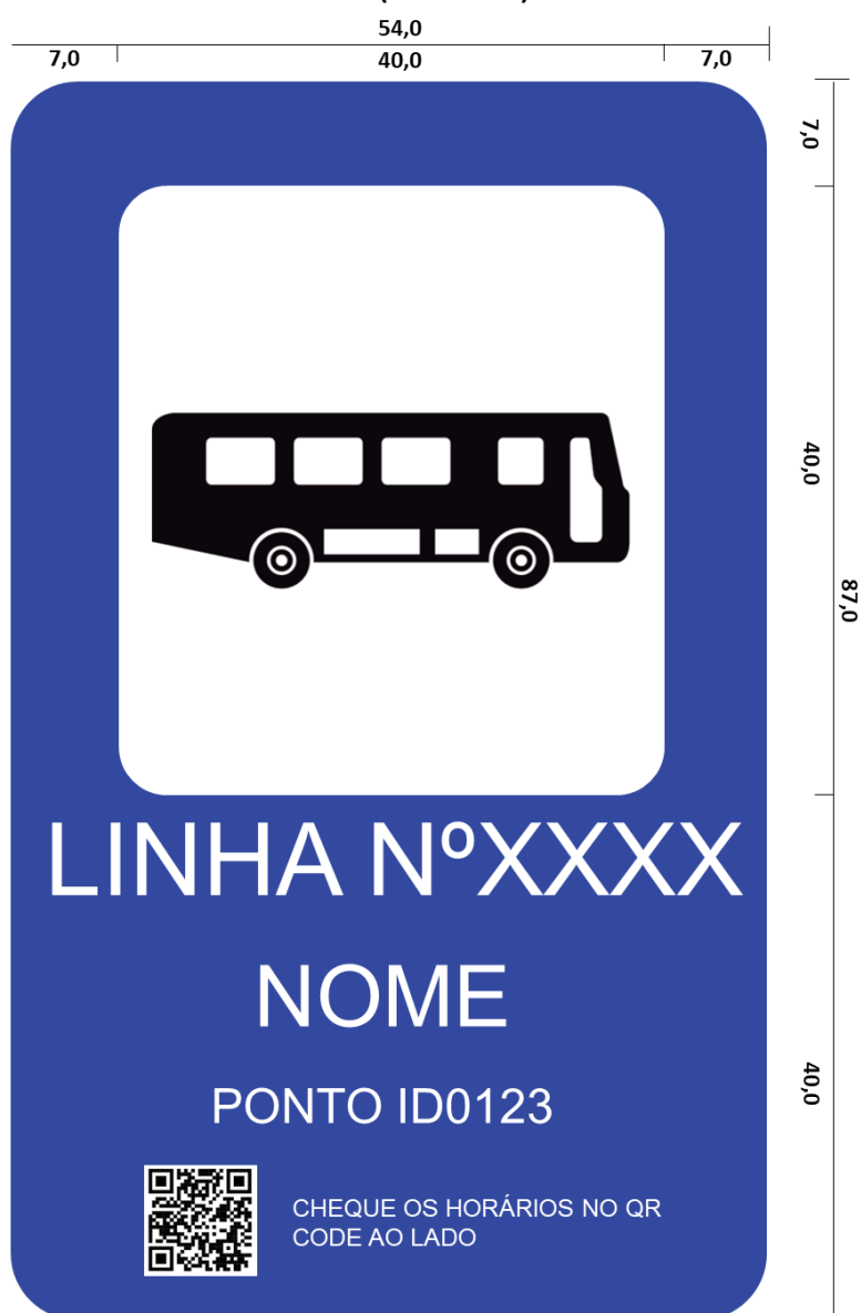
Figura 28 — Modelo de sinal indicativo de serviços auxiliares de “Ponto de Parada” (S-14) conforme CTB (sem escala)
