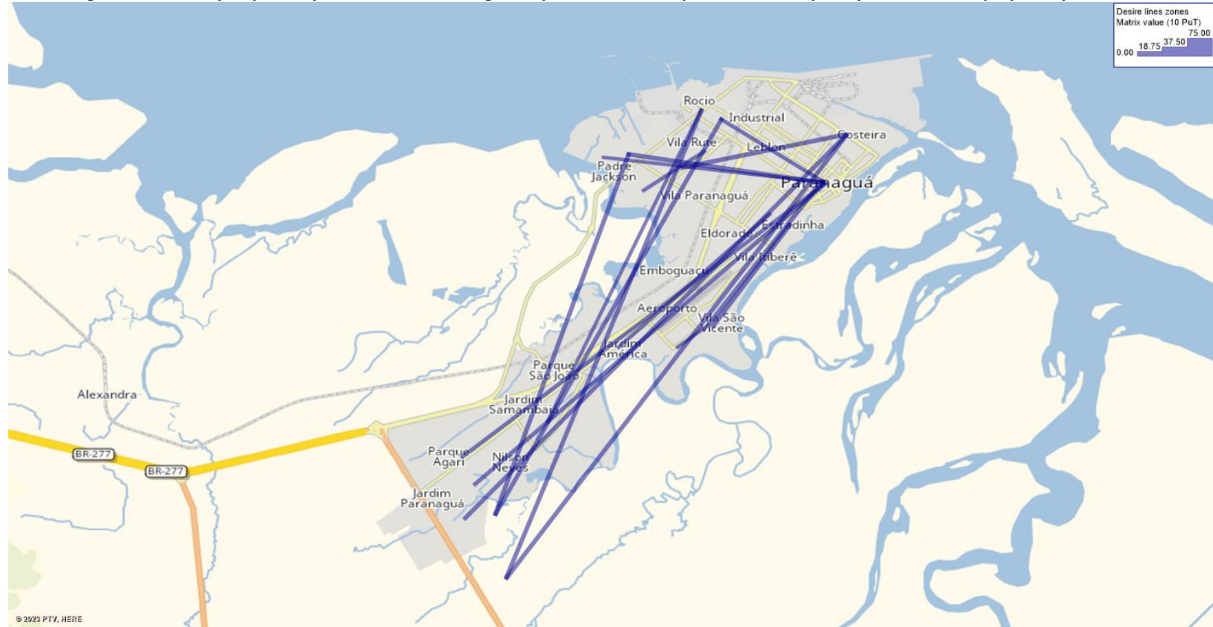
Figura 38 — Destaques para os pares entre 15 e 20 viagens, a partir da matriz expandida do transporte público, cenário proposto, pico manhã
