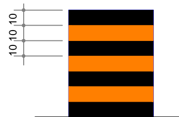
MARCADOR TUBULAR (TAMBOR DE AÇO)
