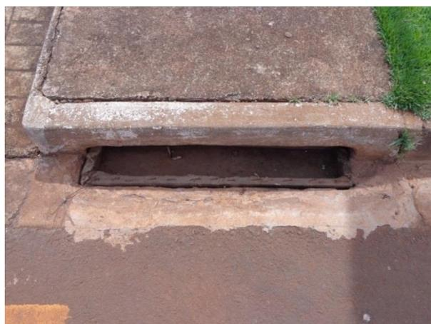
**Figura 19: Bidin na boca de lobo para coletar material particulado.**
