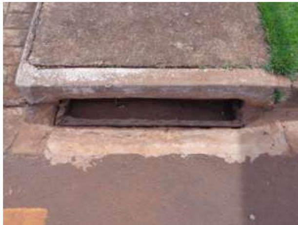
**Figura 98: Bidin na boca de lobo para coletar material particulado.**
