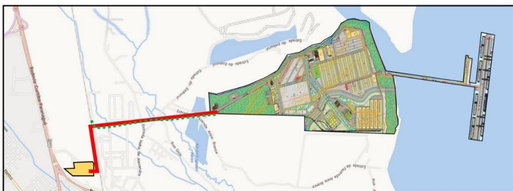
A estimativa de demanda Elétrica, considerando todos os sistemas prontos e funcionando, com a utilização dos transportes internos ainda movidos a diesel, é de 50 MVA, para isso será necessária a instalação de uma subestação em 138 kV.
