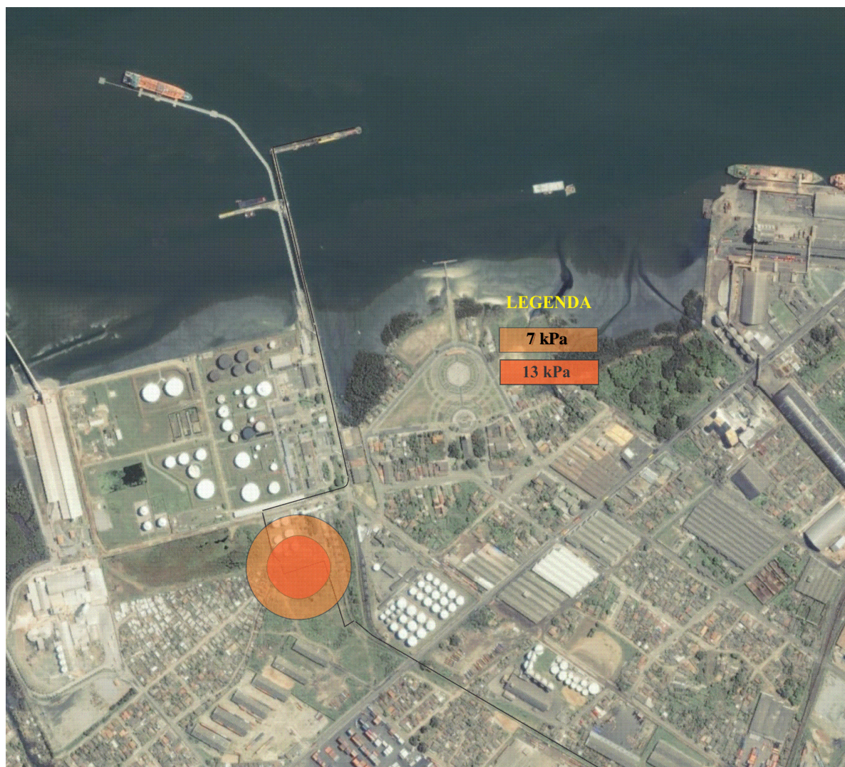
Figura 5.3- Efeitos de explosão (níveis de sobrepressão de 7 kPa e 13 kPa) em tanque, áreas vulneráveis
