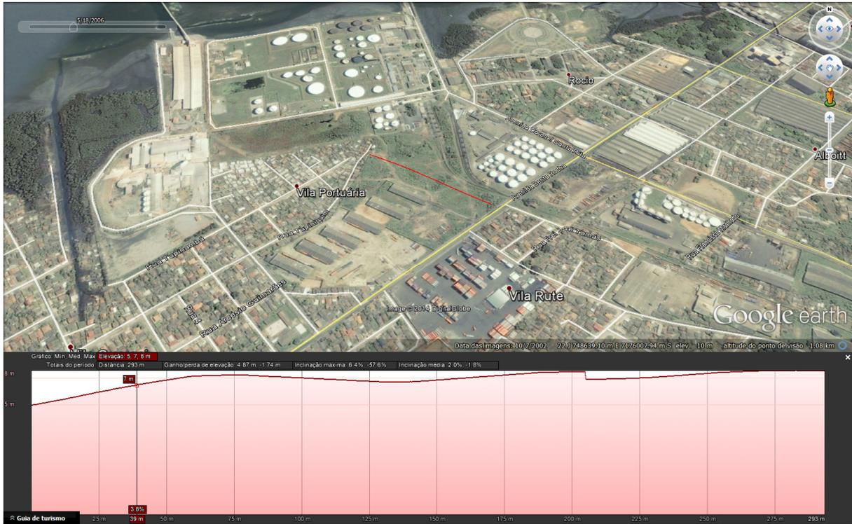
Figura 3-83 - Perfil de elevação do terreno antes da implantação.
